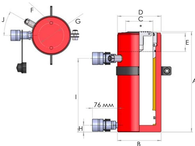
**Примечание:** Крепежные отверстия в основании (F) не рассчитаны на полную нагрузку. Данные отверстия упрощают позиционирование. Крепежные отверстия в основании на модели HDA5020 расположены под произвольным углом по отношению к БРС цилиндра.
