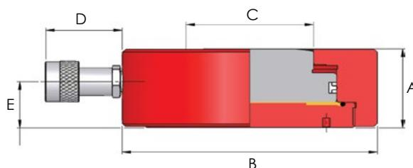
**Примечание:** Все модели, за исключением HVL100, устанавливаются с удлиняющим ниппелем для обеспечения требуемого соединительного зазора (схема выполнена без отображения соединительного удлиняющего ниппеля).
