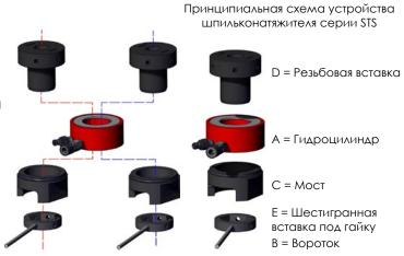
ЗАПРЕЩАЕТСЯ соединять компоненты разных цветовых маркировок. Для моделей SBT2 и SBT5 подходит только один размер моста (В1).
